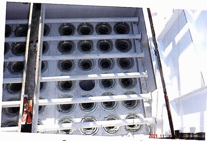
ブロー機(工場側)点検口 内部良好
